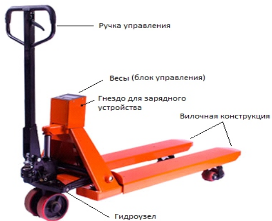
Рисунок 2. Основные части тележки.
