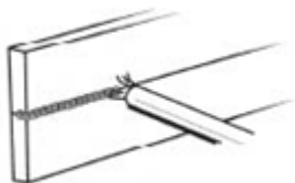
Рисунок 18. Горизонтальное положение при сварке
