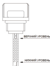
Рисунок 4. Отметки на масляном щупе.
