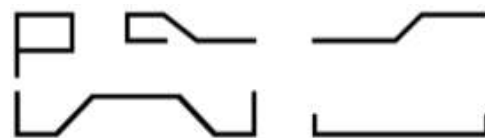
Рис. 5 Формы изгиба арматуры
