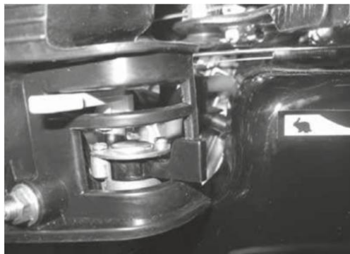
Управление топливным краном и заслонкой обогатителя
